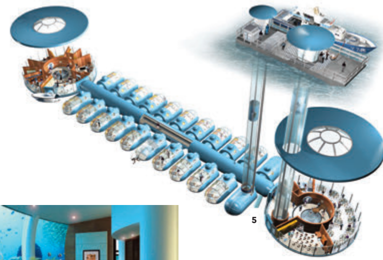
5 포세이돈 언더워터 리조트는 선박 접선 시설을 제외한 모든 시설이 물속에 들어가 있는 작은 규모의 수중 호텔이다. 왼쪽의 공용 모듈에는 잠수함 탑승용 에어록까지 마련돼 있고, 오른쪽 공용 모듈에는 식당과 승강기, 프런트가 설치된다. 6 개별 모듈화된 수중 객실의 모습. 7 몰디브 콘래드 호텔의 해저 레스토랑.
